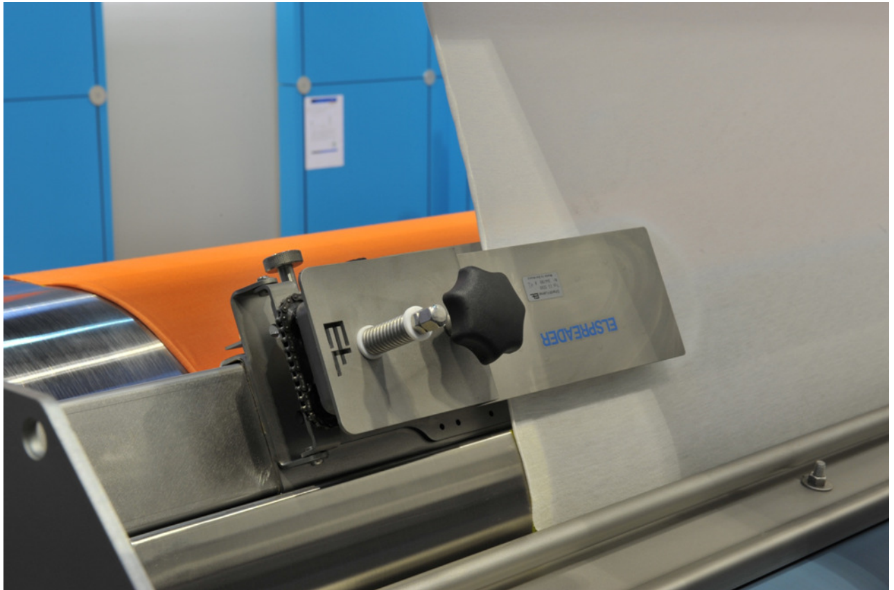
Abb. 4: BENNINGER KÜSTERS DYEPAD beim Zwickelfärben.
